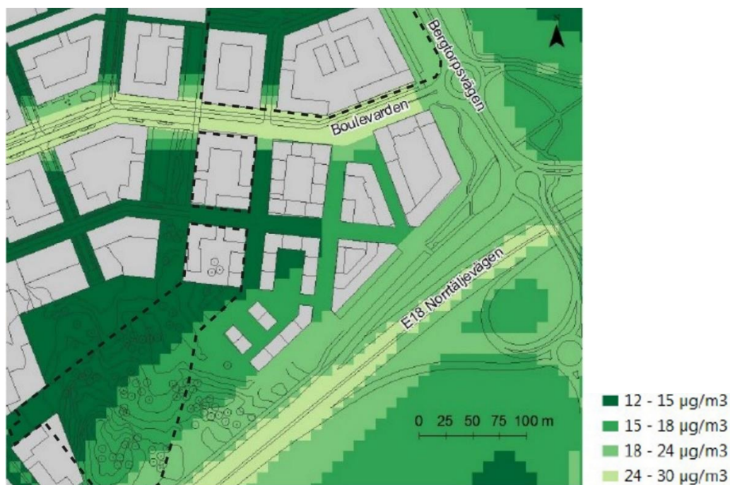
Figur 42 Beräknad dygnsmedelhalt av kvävedioxid, NO 2 (µg/m³) under det 8:e värsta dygnet vid en utbyggnad av Täby park. Normvärdet som ska klaras är 60 µg/m³. Källa (Luftutredning för Täby park, DP2, Täby, 2016)
